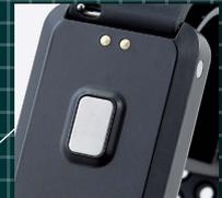
外気温度と皮膚温度を測定する2つのセンサーで身体リスクを検知。
