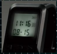
バッテリー残量や警告ステータスが確認できるバックライト付き液晶ディスプレイを搭載。
